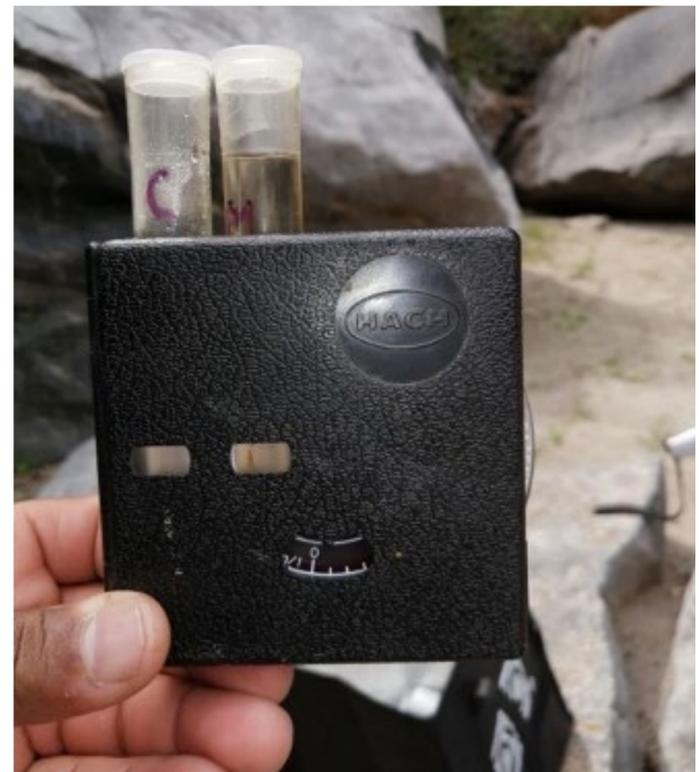
Fig. 1.3 Medición de solutos disueltos en agua. Imagen capturada por M.I. Esquivel Posadas, Mayo 2023.
