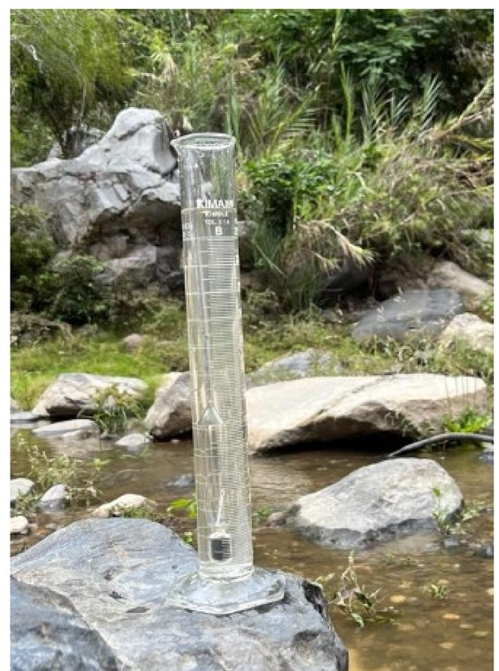
Fig. 1.2 Medición *in situ* de la densidad. Imagen capturada por M.I. Esquivel Posadas, Mayo 2023.
